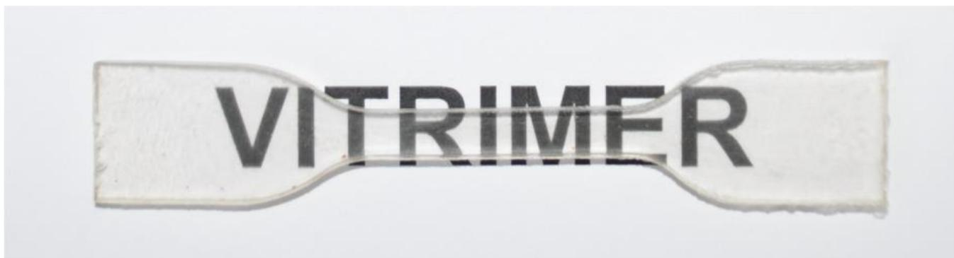
*Vitrimer de poly(méthacrylate de méthyle) (PMMA) successivement injecté-moulé, testé mécaniquement et recyclé plus de 5 fois*
